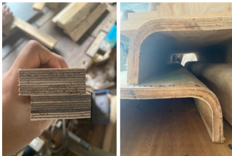
Hình 7. Đánh giá chất lượng cưa mẫu theo chiều ngang cấu kiện
