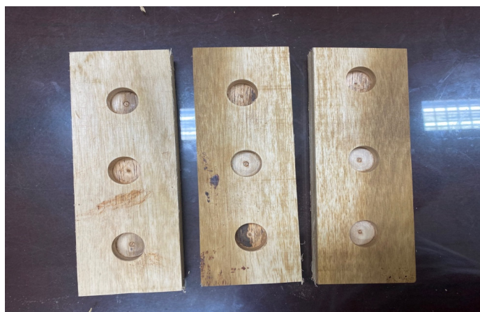
Hình 4. Đánh giá khả năng khoan của cấu kiện
