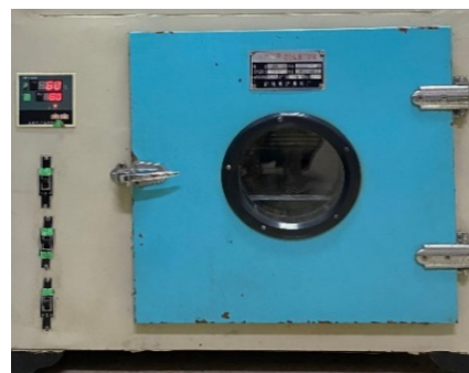
Hình 2. Thiết bị sấy lạnh kết hợp với bức xạ hồng ngoại
