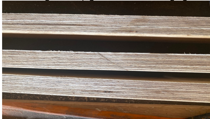
Hình 8. Đánh giá chất lượng cưa cắt mẫu theo chiều dọc cấu kiện
