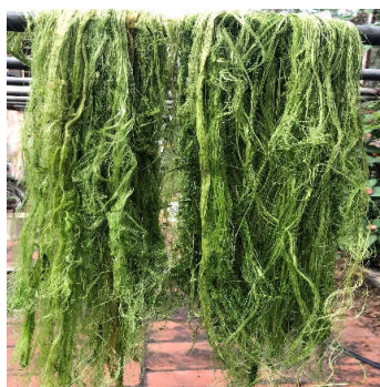
Hình 7. Sợi tự nhiên được tách từ lá dứa trên thiết bị tự động
