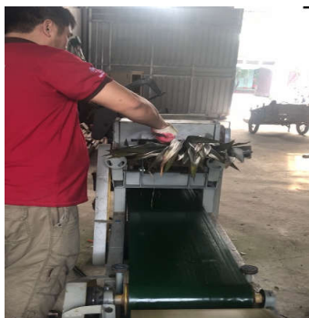
Hình 6. Tách sợi từ lá dứa trên thiết bị tự động
