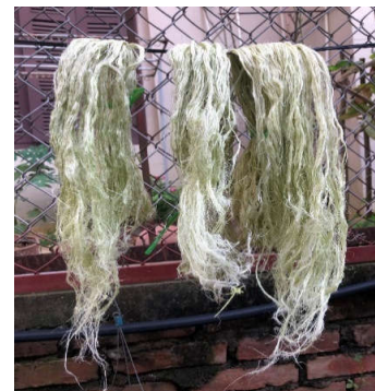
Hình 8. Hong phơi sợi dứa sau khi được xử lý làm sạch
