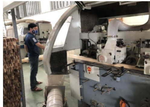
Hình 5. Bào nhẵn phôi hình thang trên máy bào 4 mặt
