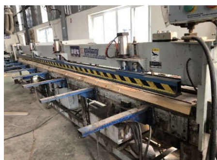
Hình 10. Ghép dài phôi hình thang trên máy ghép dọc
