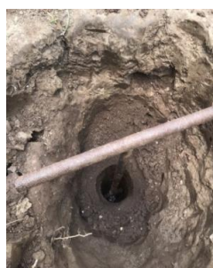
Hình 3. (a) Minh họa sơ đồ bố trí; (b) Chi tiết hố khoan đo mực nước ngầm và (c) Vị trí các trạm trong tính toán tương quan
