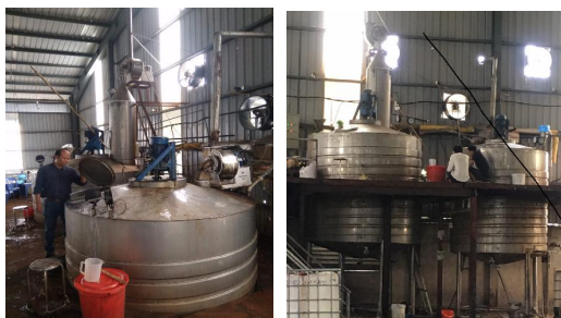
Hình 1. Thiết bị tổng hợp keo ở quy mô thực nghiệm 3000 kg/mẻ (Công ty Cổ phần Việt Nhật Hi - Tech)
