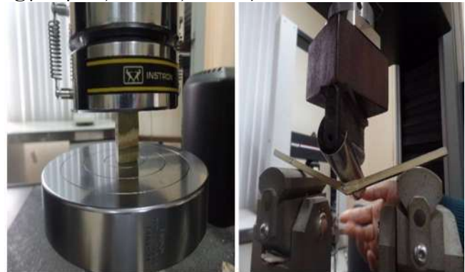
Hình 1. Thí nghiệm độ bền nén dọc và độ bền uốn tĩnh
