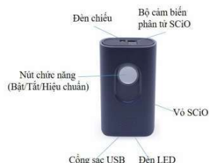
Hình 1. Thiết bị quang phổ cận hồng ngoại cầm tay SCiO™
