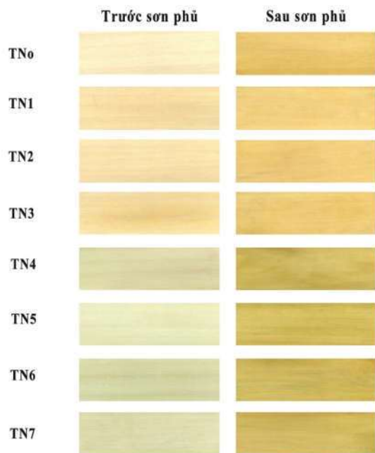
Hình 3. Hình ảnh bề mặt gỗ được xử lý bởi hỗn hợp keo nhựa thông - đồng sunphat trước và sau sơn phủ
