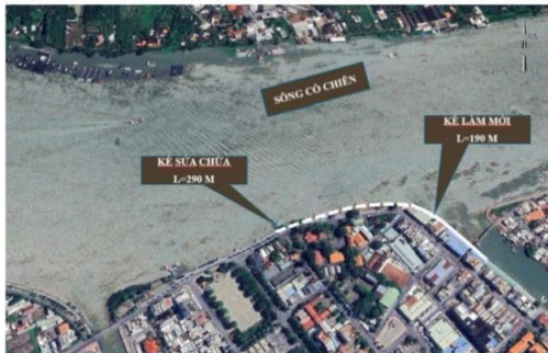
Hình 1. Khu vực đề xuất sửa chữa và xây mới kè bờ hữu sông Cổ Chiên đoạn chảy qua thành phố Vĩnh Long [5]
