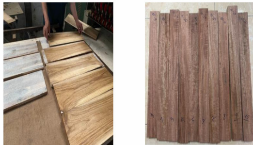
Hình 3. Dán phủ ván mỏng lên bề mặt ván dán trên máy ép cao tần
